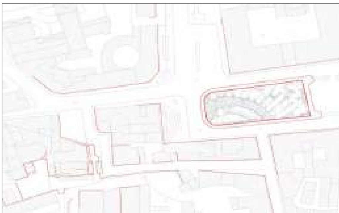
Fig. 3. OPENCiTy. Catania. Piazza Stesicoro. a) Point Clouds da rilievo laser scanner; b) CTR 1:200. In rosso correzioni apportate alla CTR 1:2000, dai profili ottenuti da laser scanner (IBAM-CNR, elab. A. Mazzaglia, S. Russo).
